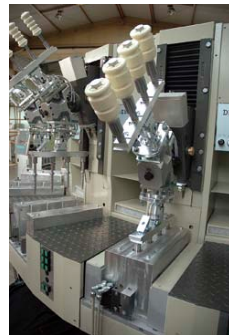
Herstellung von PU-Stoßdämpfern auf einer Bumperspeed-Maschine
